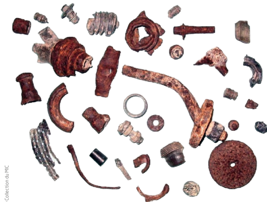
▲ Éclats vulnérants provenant du mécanisme interne d'un seul obus de 75 mm à balles inventé en 1897.
