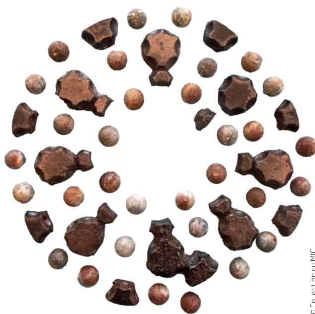
Reconstitution du début de la dispersion d'une ▲ seule galette de segments et balles à l'explosion d'un obus de 155 mm inventé en 1887.
