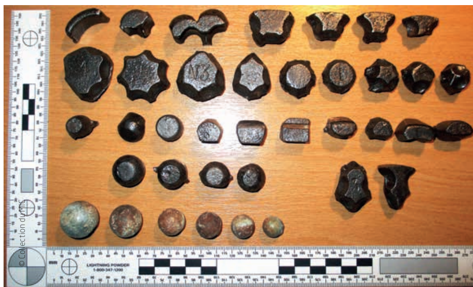
Différents segments et billes de différentes galettes de différents calibres d'obus de la fin du XIX e siècle.
