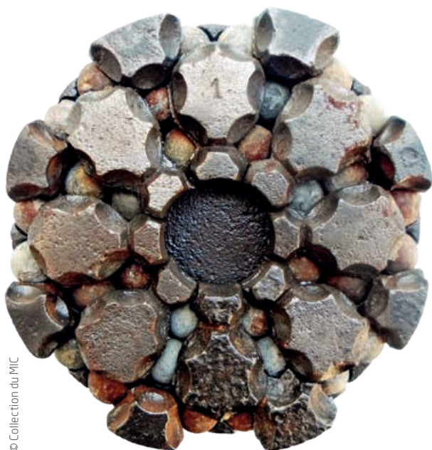
Une des 12 galettes d'un obus de 155 mm : ▲ elle se compose de 24 segments + 32 balles et pèse 1,750 kilo.
